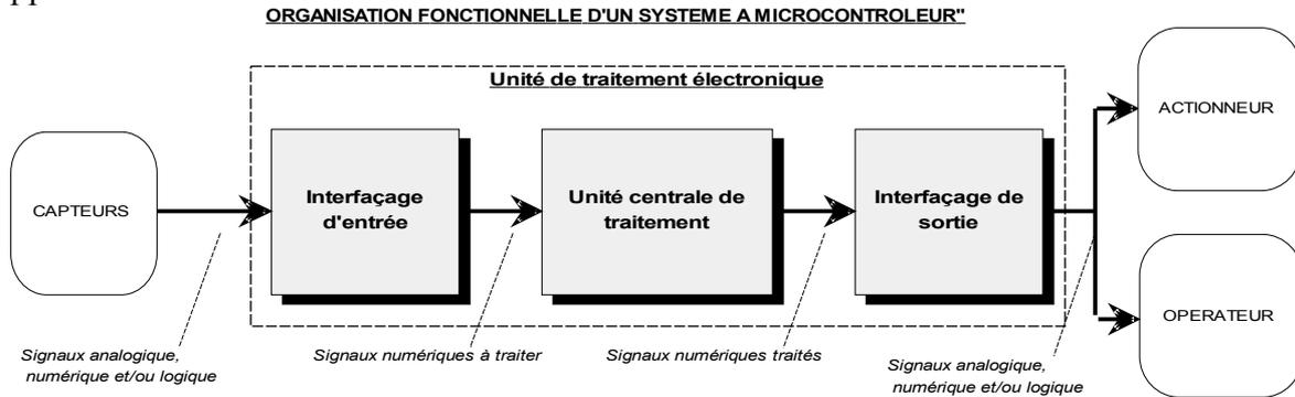
Un objet technique, intégrant de l'électronique, fait souvent apparaître des fonctions ayant pour rôle le traitement d'informations : opérations arithmétiques (addition, multiplication...) ou logiques ( ET, OU...) entre plusieurs signaux d'entrée permettant de générer des signaux de sortie.
