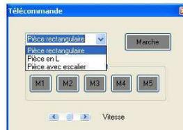
C'est d'une part le pupitre avec : un bouton poussoir **marche** bistable 2 positions et 5 boutons poussoirs de sélection de mode **M1, M2, M3, M4** et **M5**.
