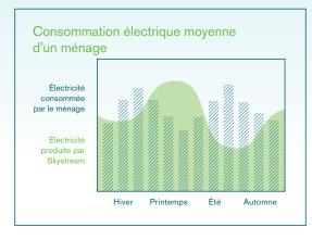
Production d'énergie basée sur les fluctuations moyennes des vitesses du vent et sur la consommation électrique moyenne d'un ménage. Différents emplacements auront des productions différentes.
