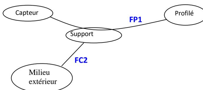
**FP1** Assurer la fixation réglable et démontable du capteur sur le profilé.
