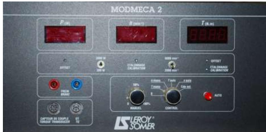
Un module électrique qui permet de mesurer des puissances des tensions et des intensités
