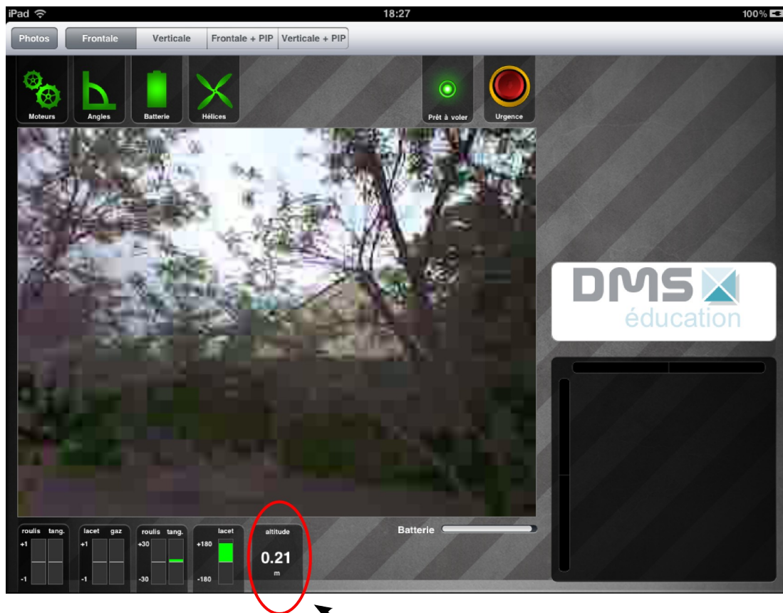
Altitude Fig. 119: Mesure de l'altitude avec l'application "Piloter"
