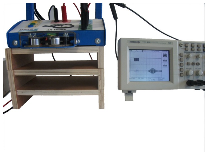
Fig. 118: Utilisation de cales de 5cm
