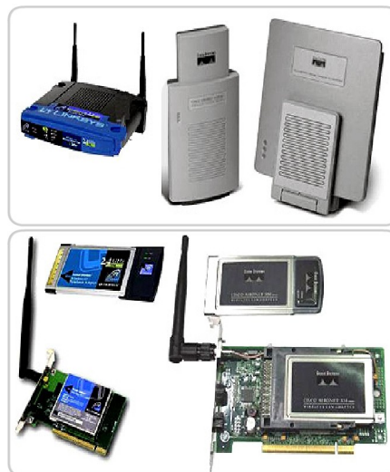
Fig. 65: Point d'accès et carte Wi-Fi
